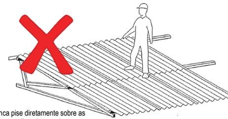
Nunca pise diretamente sobre as telhas, isso pode causar acidentes, além de provocar trincas e vazamentos
