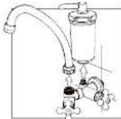
3. No caso da bica móvel com purificador, se não houver espaço para a instalação, desmonte a bica da torneira retirando sua porca e retire o copo do purificador;
