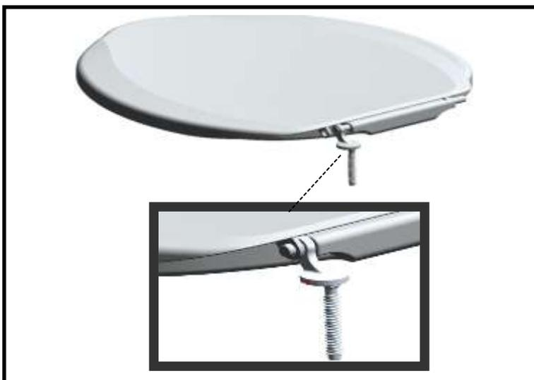
2. Posicione o Pino de fixação do assento para ambos os lados no eixo do aro e remonte a tampa;
