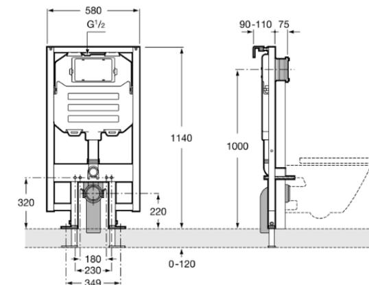
Esta caixa destina-se à instalação de bacias convencionais de piso com caixa embutida e/ou quando se busca a estética da placa de descarga. A instalação pode ser realizada em parede de Alvenaria ou em uma construção de dry wall.
