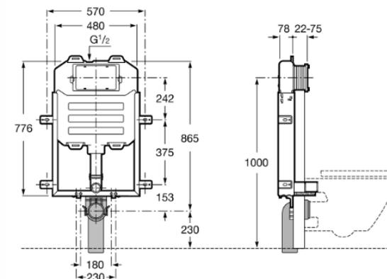
Este suporte destinam-se à instalação de uma bacia suspensa com uma cisterna embutida em uma parede resistente e/ou quando se busca a estética da placa de descarga. A instalação pode ser realizada em uma parede sólida revestida com gesso ou em uma construção de drywall “pura”, ou seja, sem qualquer parede de tijolo / concreto envolvida.
